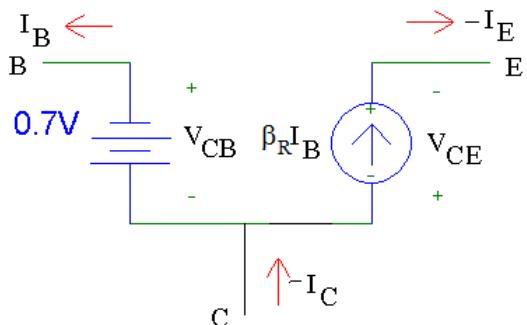
$$V_{BC} = 0.7V \quad V_{EC} > 50mV$$
